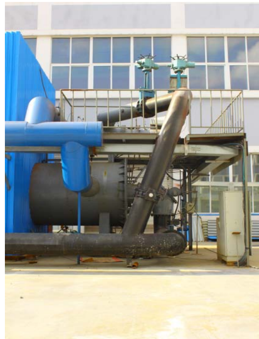
热态演示/试验台已安装完毕的等离子发生器与热裂化室
