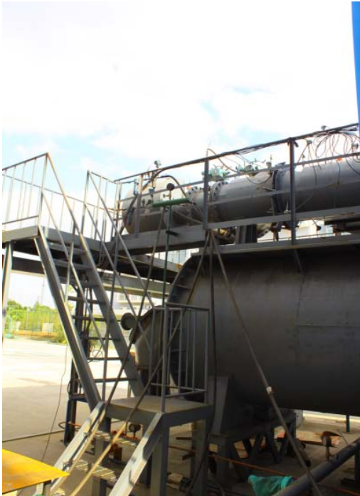
热态演示/试验台已安装完毕的等离子发生器与热裂化室
